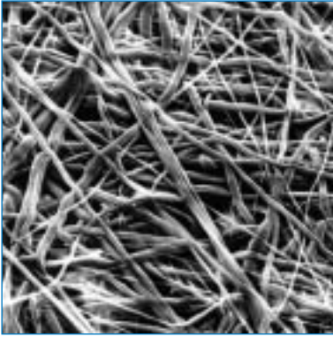
Klearfil Polypropylene Media (x250)
